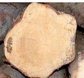
**13** **Weichfäule** wird von Mikropilzen verursacht, die Zellulose und Hemizellulose zersetzen und die Festigkeitseigenschaften des Holzes vermindern. Sie tritt in fortgeschrittener Ausprägung flächig, oftmals zentrisch auf. Rückeschäden wird durch Zulassen von Weichfäule im äußeren Bereich des Wurzelanlaufs in Qualitätsklasse D Rechnung getragen.
